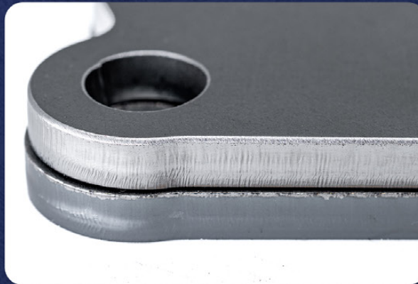
Entfernung der Oxidschicht
