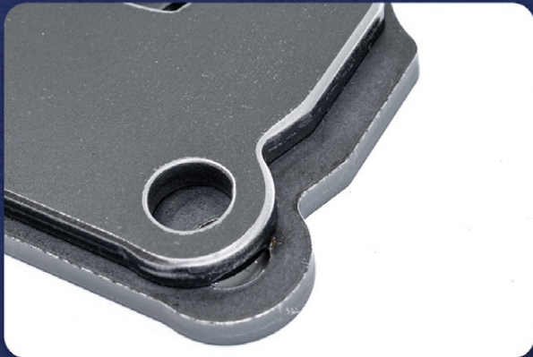
Entgraten und Kantenverrunden - Stahl
