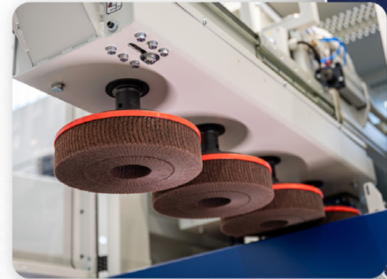
Tellerbürsteneinheit mit Scheiben Durchmesser Discmatic 260
