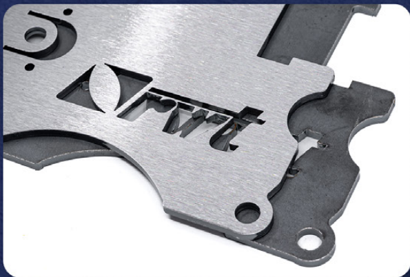
Aufrauhung der Materialoberfläche
