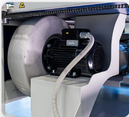
Wentylator próżniowy wbudowany wewnątrz maszyny
