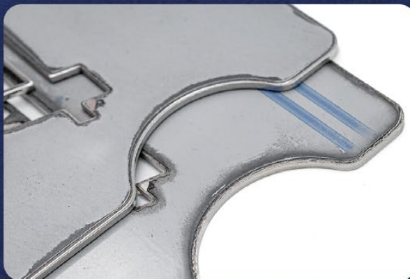
Zaokrąglanie krawędzi elementów foliowanych bez uszkodzania folii ochronnej
